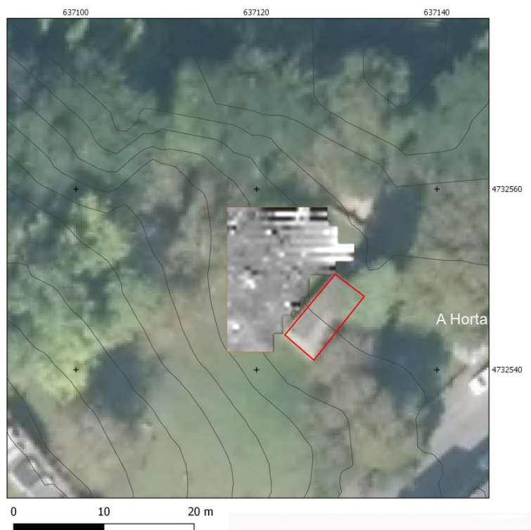
Figura 3. Ortoimagen del área de la capilla con los resultados de la prospección geofísica mediante gradiómetro.
